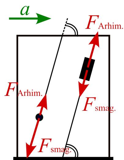
Pa labi ir uzskicēta situācija ar iezīmētiem Arhimēda un smaguma spēkiem (sastiepuma spēks nav iezīmēts). Kā papildus nosacījumu šim eksperimentam var ievērot, ka abas auklas—aukla, kurā ir iekārta lodīte, un aukla, kurā ir iekārts korkis—būs vienādā leņķī pret burkas pamatni.
