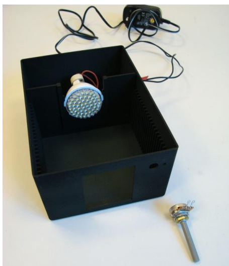
2.2. attēls. (a) Kaste ar gaismas avotu un izņemtu rezistoru. (b) Kastē iestiprināts rezistors. Ievēro, ka mazs pulķis uz rezistora ir ievietots caurumā kastē pa labi no rezistora ass.
