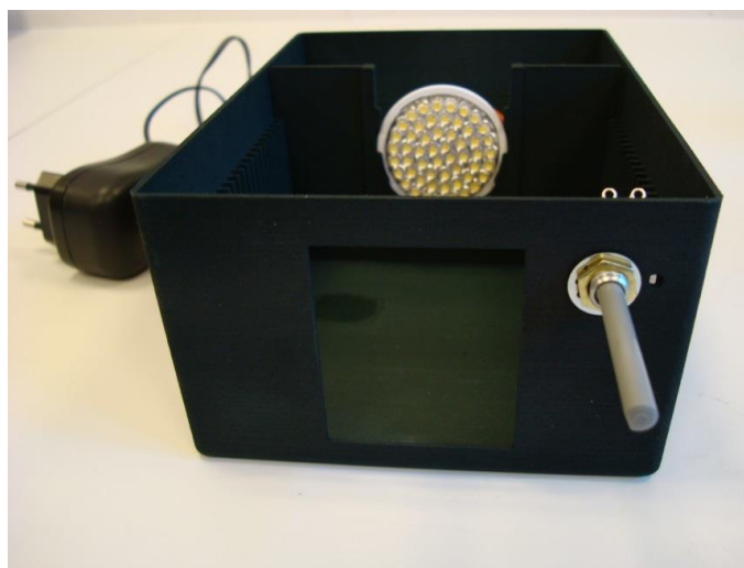
2.2. attēls. (a) Kaste ar gaismas avotu un izņemtu rezistoru. (b) Kastē iestiprināts rezistors. Ievēro, ka mazs pulķis uz rezistora ir ievietots caurumā kastē pa labi no rezistora ass.
