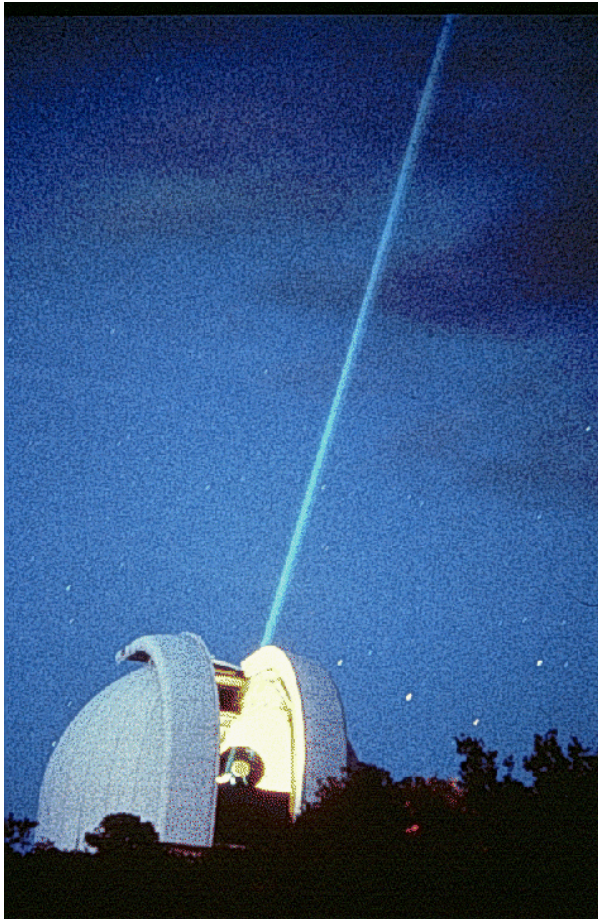
1. attēls. No observatorijas raidīts lāzera stars tiek izmantots, lai precīzi izmērītu attālumu no Zemes līdz Mēnesim.
