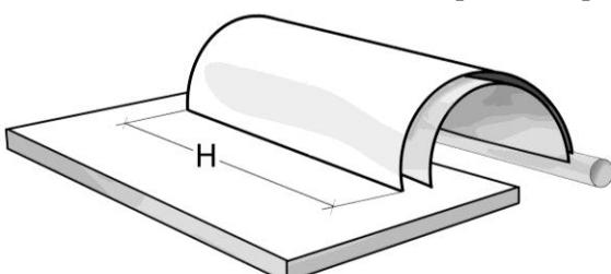
«**Детектор фотоэлектронов**» Рентгеновское излучение длины волны  $\lambda = 0,84 \text{ нм}$  падает на плоский образец чистого металла и выбивает из него электроны. Для определения их энергии используется несложное устройство (см. рисунок): две близко расположенные концентрические согнутые в полуцилиндры металлические пластины шириной  $H = 10 \text{ см}$ , заряженные противоположными зарядами одинаковой величины.
